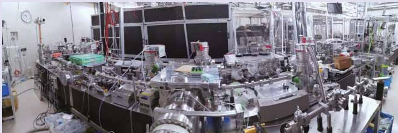
近赤外レーザー光の高調波発生装置と極端紫外光パルスを用いたレーザー加工の実験装置。
