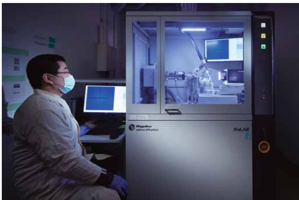
「不斉亜鉛」錯体の単結晶X線構造解析を行っている様子
