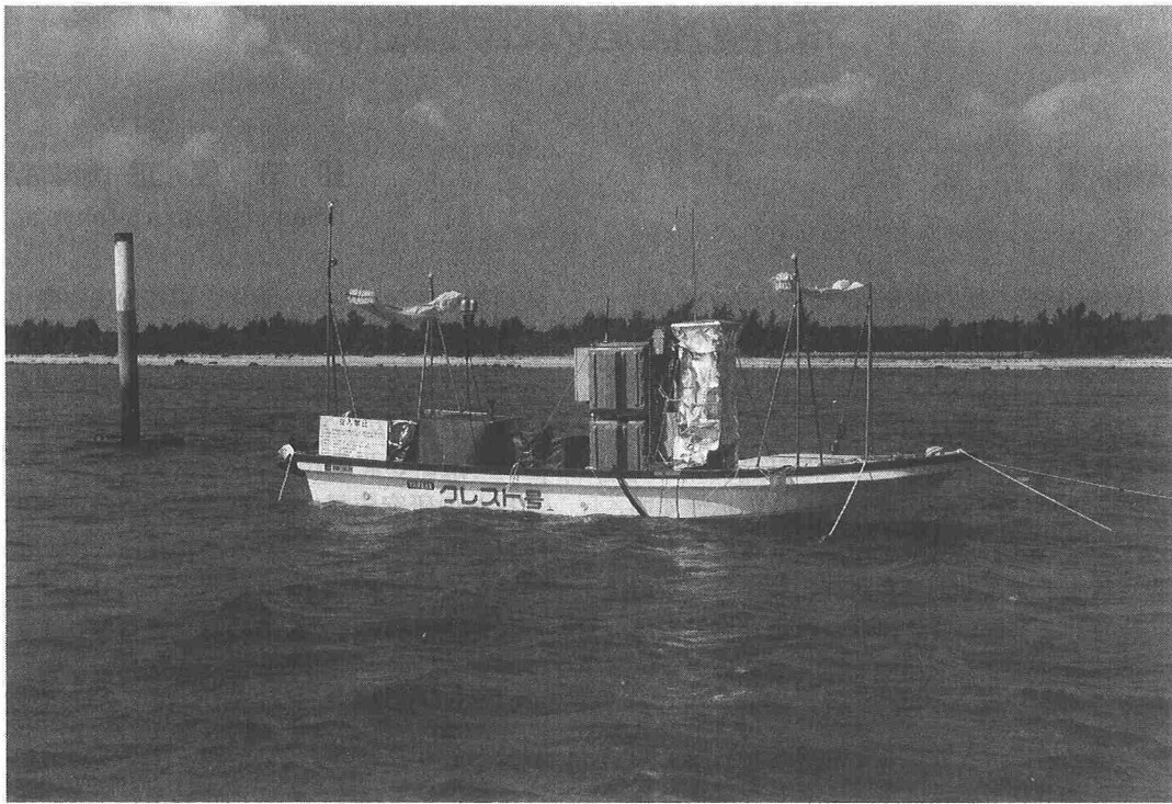
写真 石垣島白保サンゴ礁上に係留され、サンゴ礁海水中の CO 2 系の計測を行うクレスト号。
