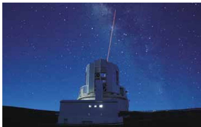
図1: 天の川を観測する「すばる望遠鏡」。レーザーで参照人工星を打ち上げる「補償光学」観測も今では普通になった。(提供:D.バーチャル(Dan Birchall)国立天文台ハワイ観測所)
