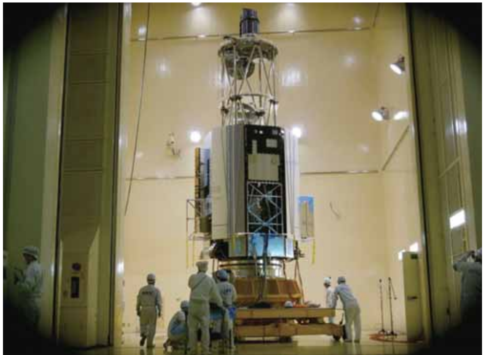
筑波宇宙センターにて、音響試験に臨むASTRO-H衛星。高さ8m、重さ2.5tの衛星を、慎重に試験室に運び入れる。（JAXA提供）
