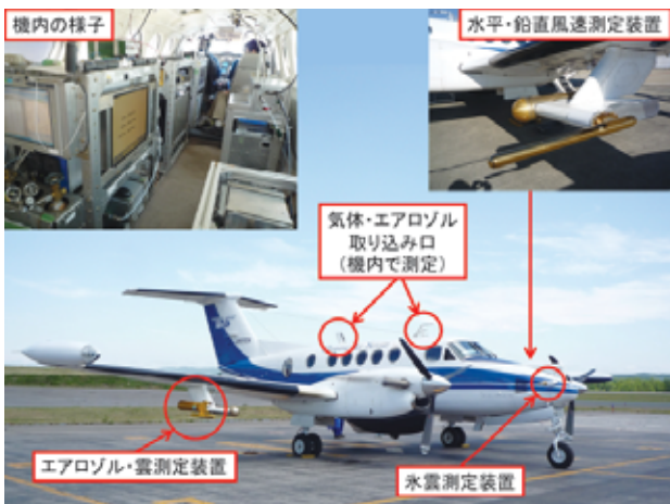
2009年と2013年の観測で使用した航空機。機内には世界最先端の測定機器がずらりと並ぶ。パイロット2名と研究者2名を乗せて、未知の現象の解明に挑む。
