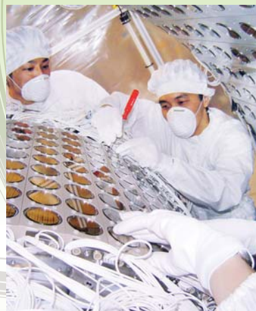
e: MEG実験の液体キセノン \gamma 線検出器に光電子増倍管をインストールしている大谷助教(右)。
