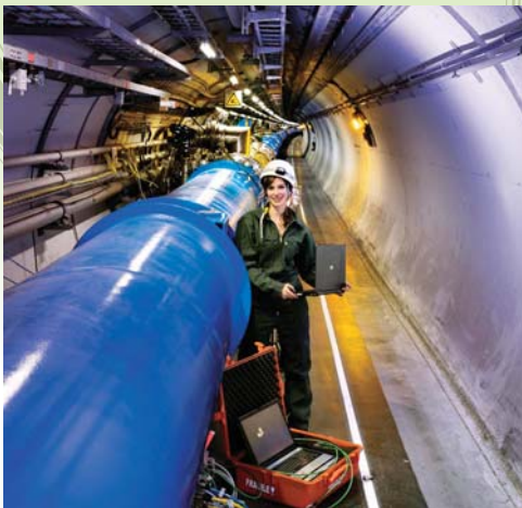
d: LHC加速器のトンネルの内部。超伝導電磁石をCERNの技官が調整している。この中を2本の陽子ビームが走る。遠方を見るとわずかな曲率でトンネルが曲がっている(写真提供: CERN)。
