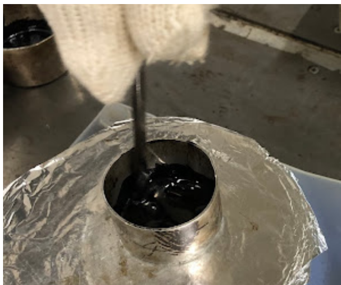
アスファルトと自分の持ち込んだ酸化鉄材料を混合している様子。
