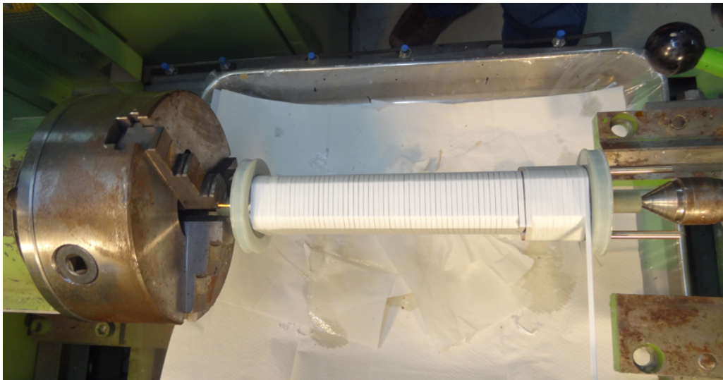
磁石製作の様子。コイルの外側にガラス繊維チューブを巻きつけている。
