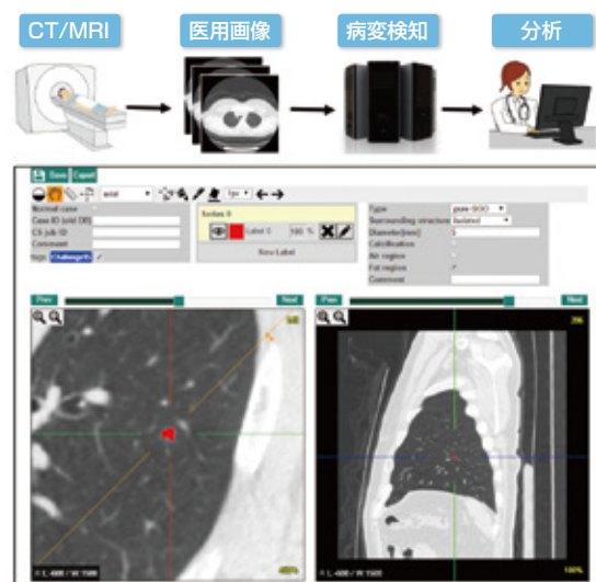
東大病院と共同開発している読影支援システム。CTやMRIでスキャンした画像を収集し、病変検出によって読影を支援する。
