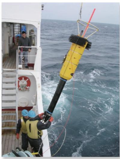
超深海乱流計を使った海洋観測。水深6000mまで自由落下しながら数cmスケール以下のミクロな乱流の強度を測定します。
