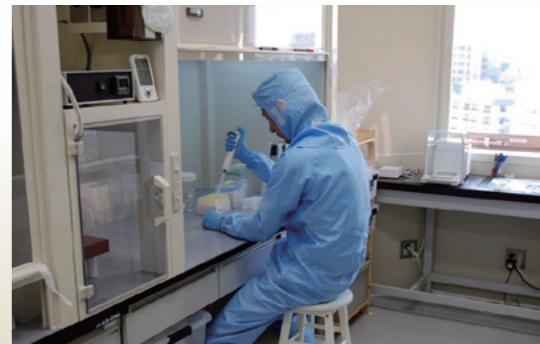
▲高精度化学・同位体分析に必要なクリーンルームでの化学分離作業
