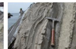
▲地層の向きや傾きを計測して、それを地図上にプロットして行く。
