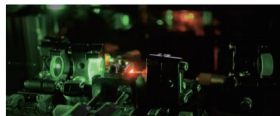
図1: 高速ラマン分光を可能とする光周波数コムレーザー発生装置。
