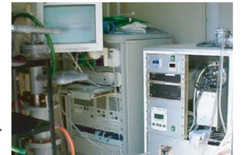
地下水溶存ガス連続測定装置
