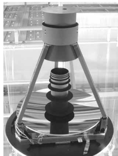
図2. 赤外線衛星ASTRO-F冷却望遠鏡の写真。70cmの炭化珪素（SiC）の鏡が用いられている（写真提供・宇宙航空研究開発機構宇宙科学研究本部）
