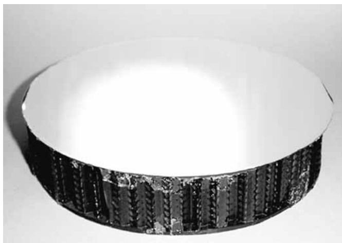
図 3. レプリカ法により制作した炭素繊維強化プラスチック材 (CFRP) の 15cm 試作鏡
