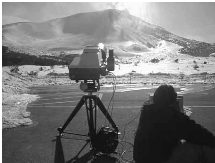
図 浅間火山における太陽散乱光を光源に用いた火山ガスの赤外吸収スペクトル測定
