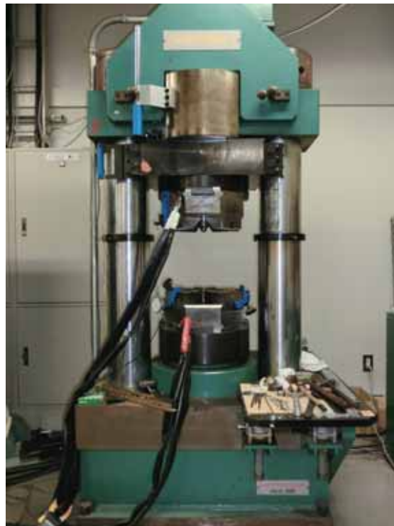
高圧実験に用いた大型プレス (東大物性研物質設計評価施設にて)
