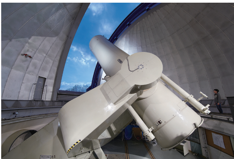
1974年の開設以来活躍を続ける、口径105cmの「シュミット望遠鏡」
