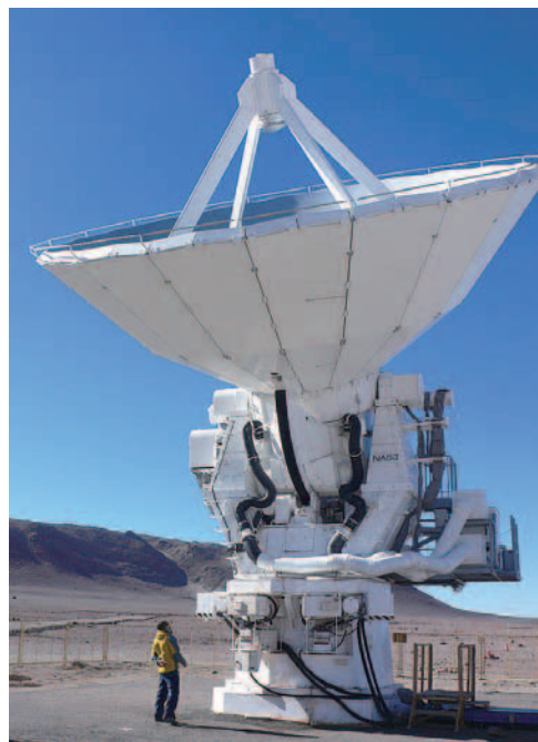
口径10mのサブミリ波望遠鏡「ASTE」。アタカマ砂漠の中で、パンパラボラとよばれる平原の、標高4,860m地点に設置されている。
