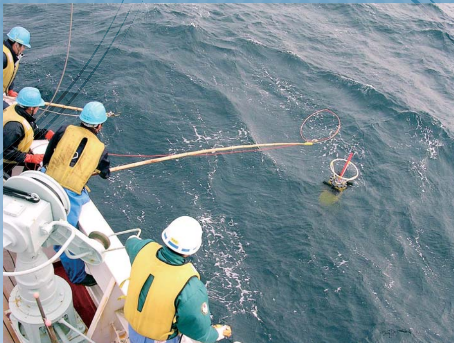
超深海乱流計 VMP-5500 の回収風景 (小笠原諸島沖合)
