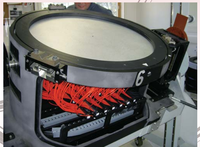
c: 640本の光ファイバーにつながれた穴あきアルミ板
