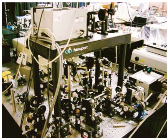
図1：スペクトル化学研究センターで独自に開発したフェムト秒時間分解近赤外分光計。測定精度を上げるために、2台の分光器（写真の上端と右下）を使っている
