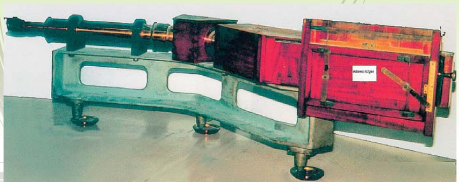
戦前から戦後にかけて化学教室において使用されたプリズム式写真分光器
