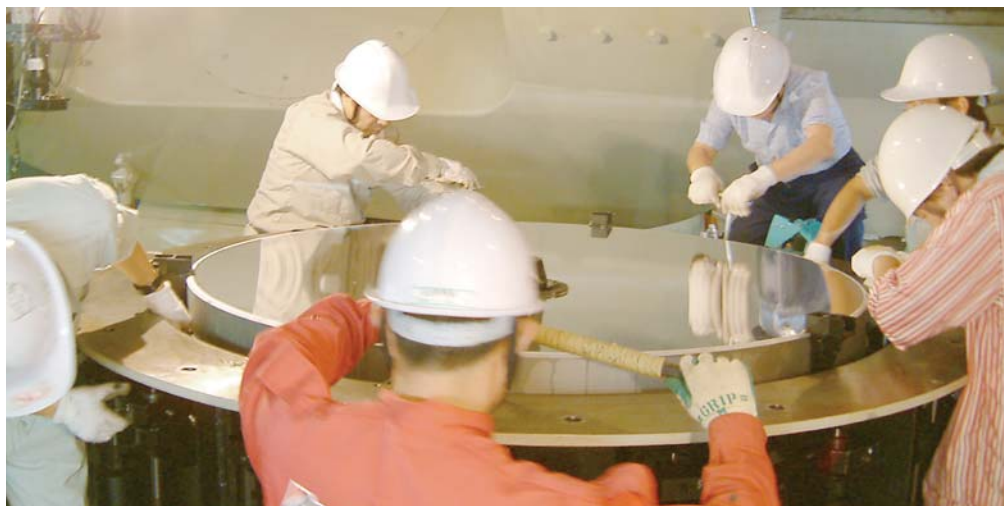
■ 図6：望遠鏡のメンテナンスの一環として、主鏡の分解洗浄を行う所員
