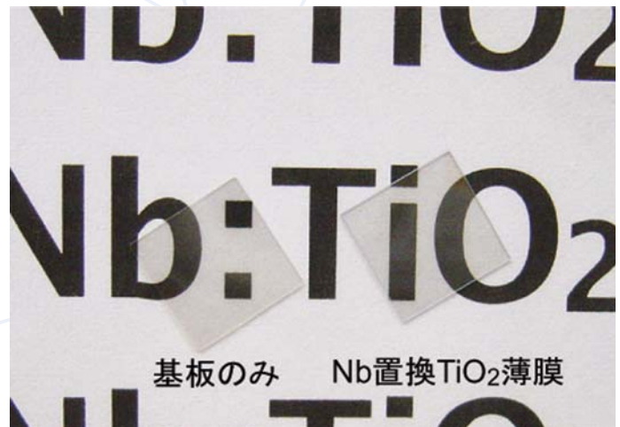
■ 図 2 : チタン酸ストロンチウム基板 (左) と同基板上に堆積したニオブ置換二酸化チタン薄膜 (右) の写真
