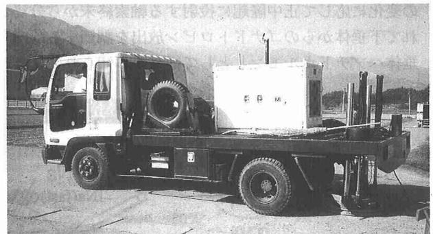
写真：震源車。荷台中央の白い箱は油圧発生装置。荷台最後部に付いている油圧バイプレーターで路面を揺する。長野県神城盆地にて。
