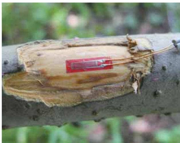
図2：建物の写真が撮りたくてカラマツに登ったわけではない。樹木には自重や風などによる力学ストレスがかかっている。このストレスと樹形との関係を明らかにするためにカラマツに登り、カラマツの下から上までこの写真のように歪みゲージを取り付けた。これによって幹や枝に生じる応力を知ることができるようになった。樹木の個体全体に多数の歪みゲージを取り付け、応力をくまなく測定したのは世界で初めてのことで、ゲージのメーカーは生きた木への取り付けという想定外の使用に困惑していたが、良い方法を考案してくれた。測定は現在も続いていて、結果を見るのが毎日楽しい。樹木の太い幹の場合、風速100m/秒でも折れることはないようだ。
