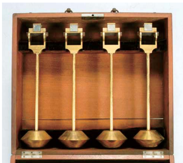
ステルネック (Sterneck) 型の重力振子。長岡半太郎らがポツダムと東京の間で比較測定をして日本の重力の値を確定するのに使用したと伝えられるもの (国立科学博物館蔵)。
