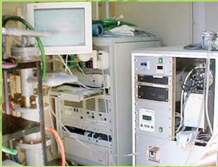
御前崎観測井戸に設置した地下水溶存ガス連続測定装置
