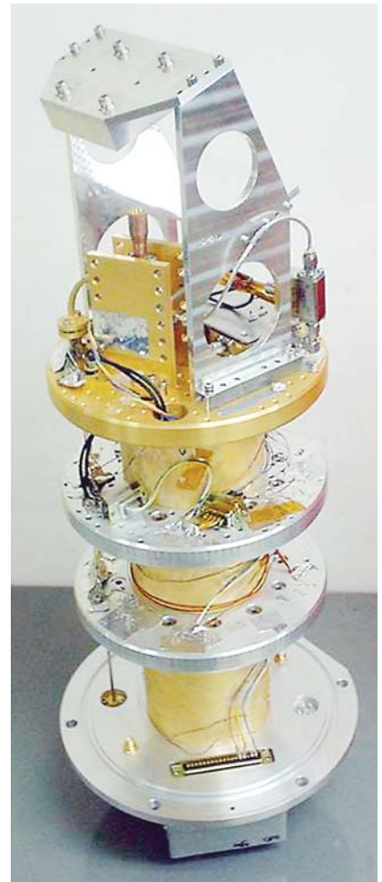
図3：チリで運用中のASTEに搭載された超高感度サブミリ波受信機
