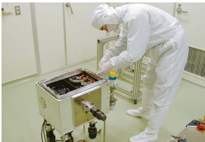
図1: 教育研究棟実験室で組み立て中の赤外線分光器
