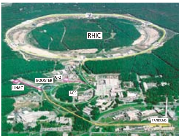
図1: 米国ブルックヘブン国立研究所のRHIC重イオン衝突型加速器。100GeV/核子の金同士の衝突を可能とする。
