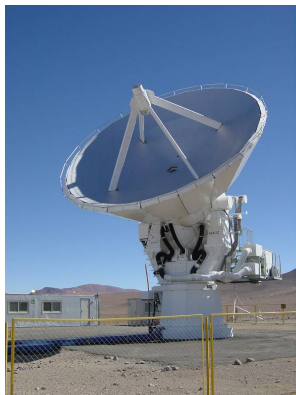
図 2：南米アタカマ砂漠の高地に設置された、口径 10m のサブミリ波望遠鏡「ASTE」。
