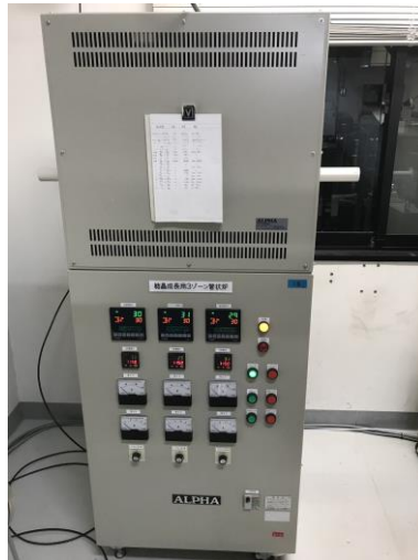
今回の共同研究で使用した3ゾーン管状炉
