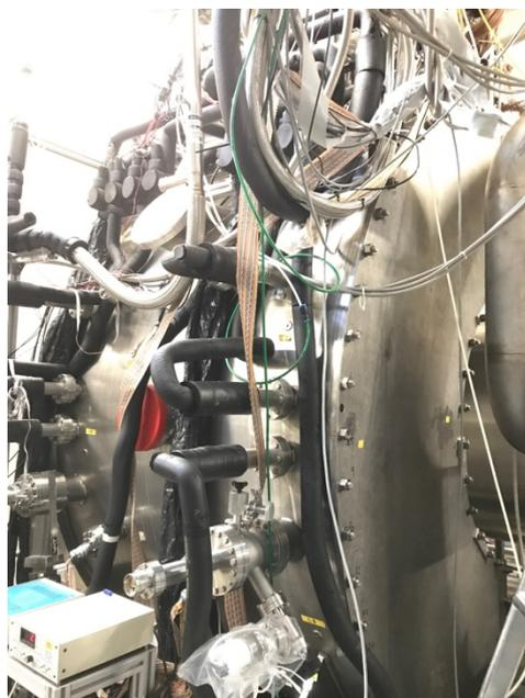
図：本研究で運用・データ解析を行った液体キセノン検出器
