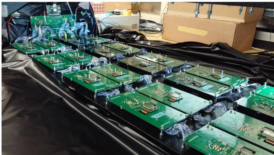
写真 1：フロントエンド基板を 20 枚接続して読み出している様子
