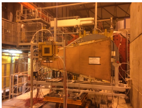
図 1 検出器のビームテストの様子。奥に見える台形の検出器がテストしている試作機。
