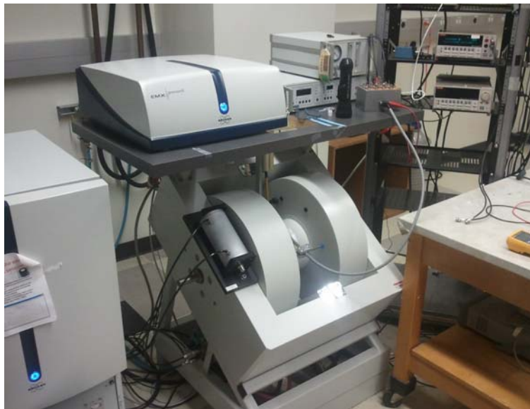
測定に使用した電子常磁性共鳴装置
